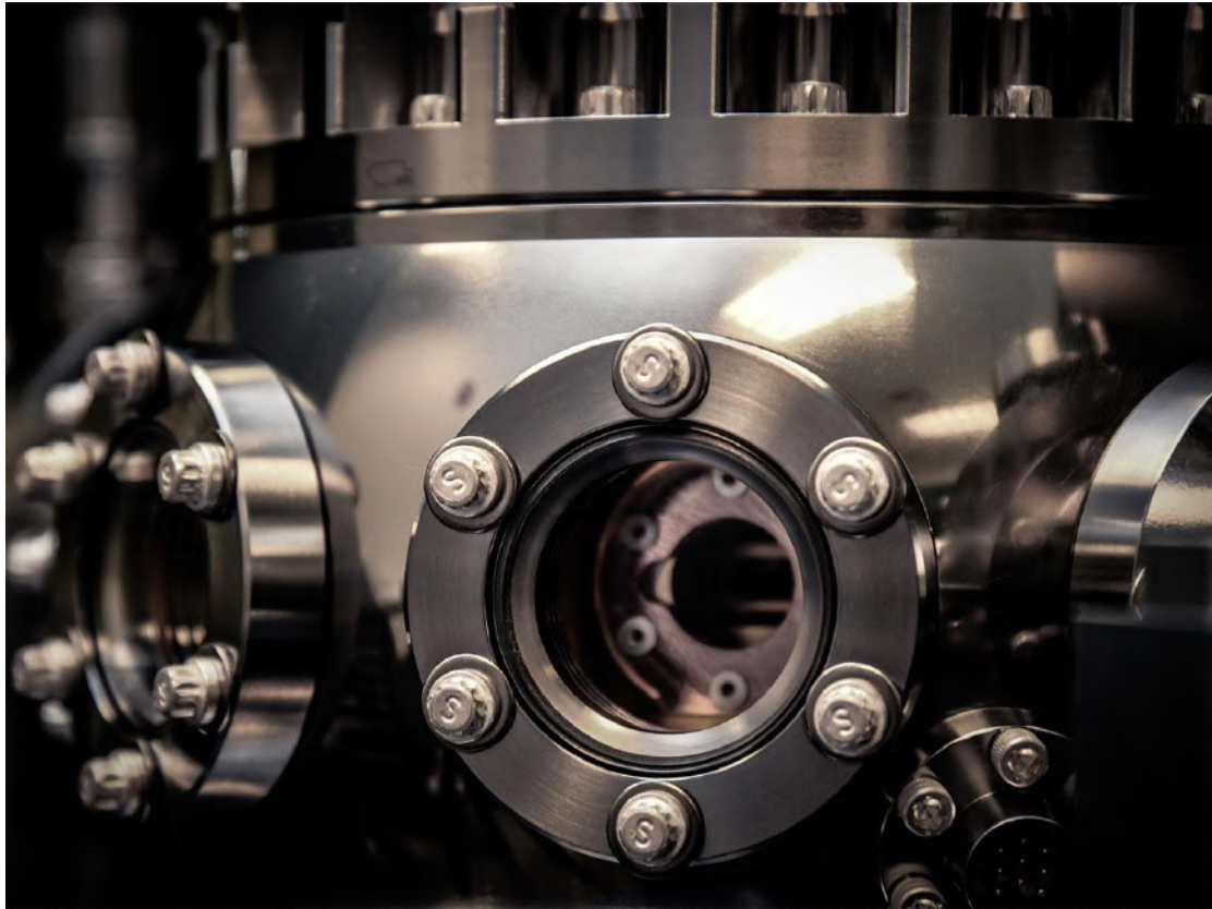
图 11 霍尼韦尔离子阱量子计算机使用的真空腔
