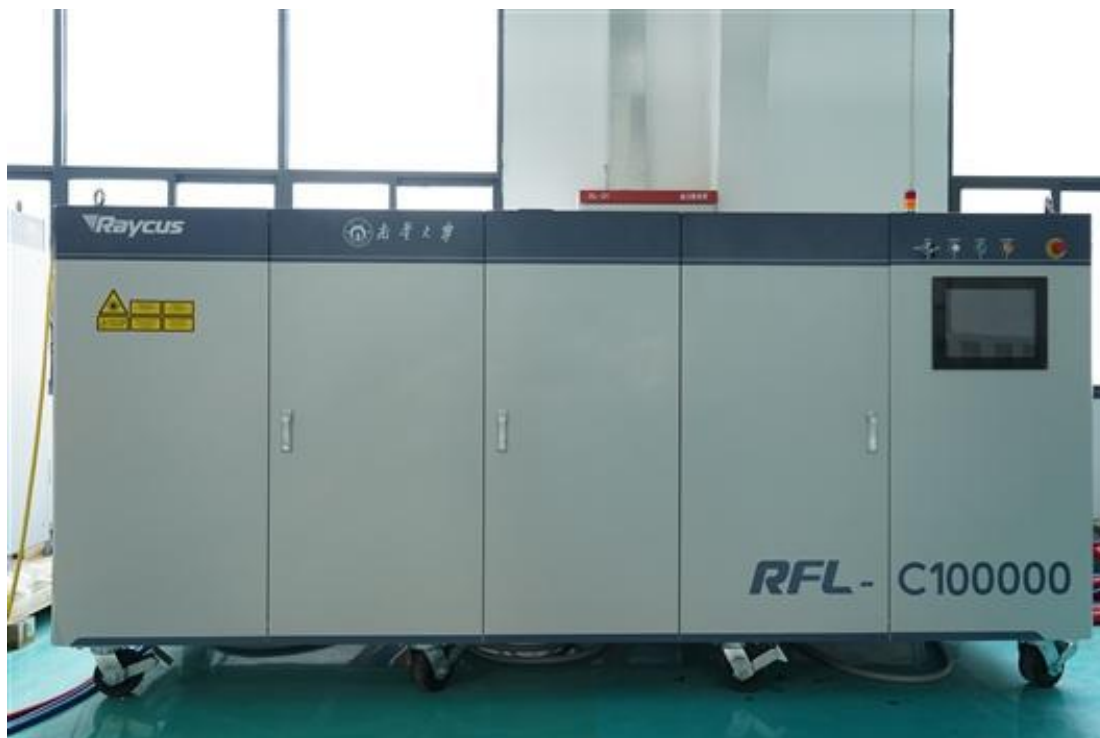
图12 国内首台100kW超高功率工业光纤激光器
