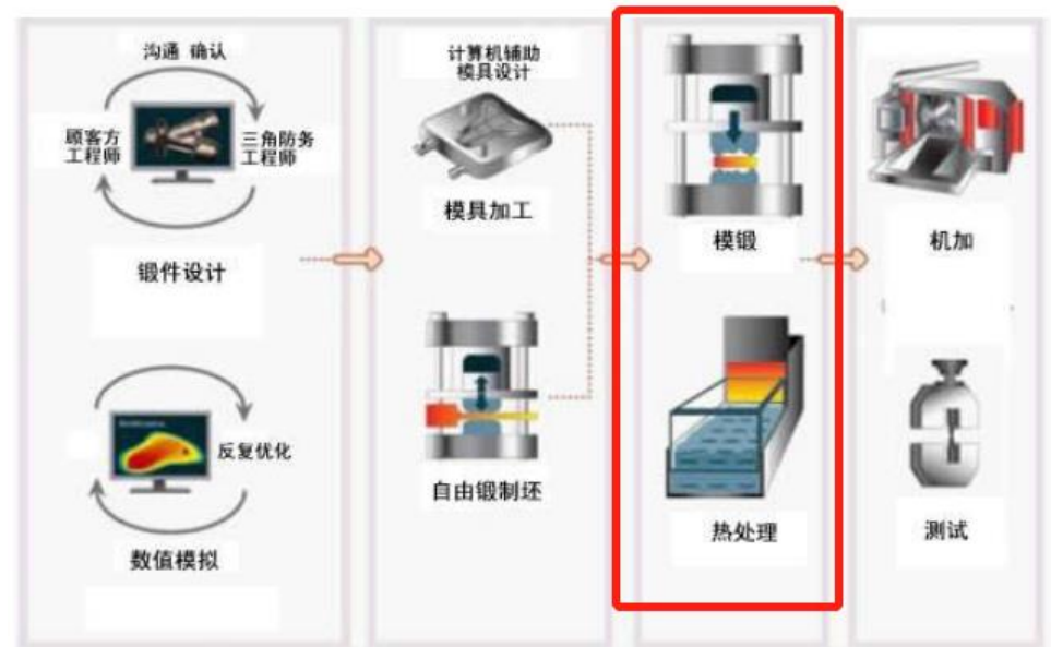
图33：热变形+热处理为航空中游锻造环节的核心工艺
